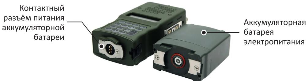
Установите аккумулятор, совместив основание радиостанции и контактный разъём батареи под углом, затем поверните аккумулятор по часовой стрелке, пока он не зафиксируется с корпусом радиостанции.
